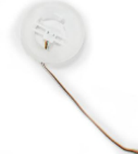
Пластиковые детали маленького звукового сигнала на правой задней двери
