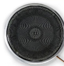
Пластиковые детали маленького звукового сигнала на правой задней двери
